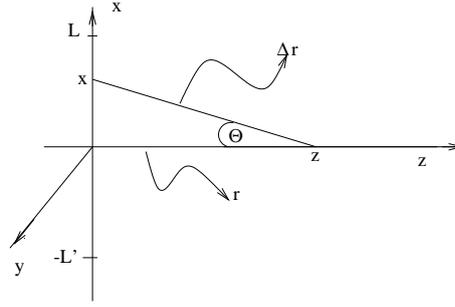
Figure 1.1: Distribuição linear de cargas.
